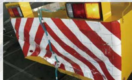
Bタイプの緩衝くんを取り付けた停止中の標識車に、乗用車が60.5km/hの速度で追突した実験結果です。
